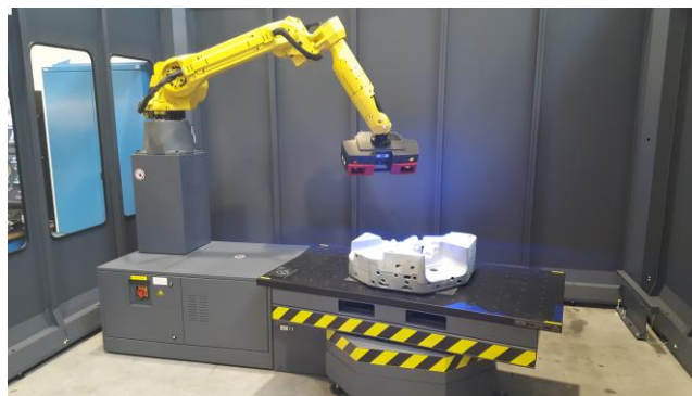
Slika 16. Skeniranje gravure alata za tlačni lijev
