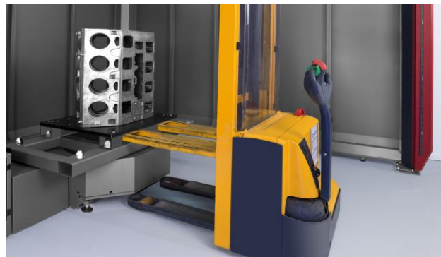
Slika 2. Namještanje pomoću viličara
