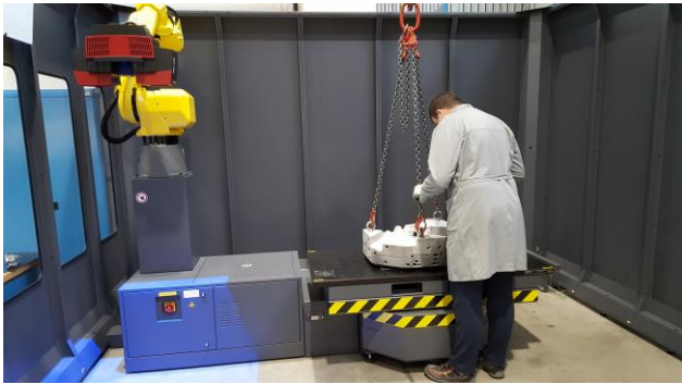
Slika 3. Namještanje mostovnim dizalom
